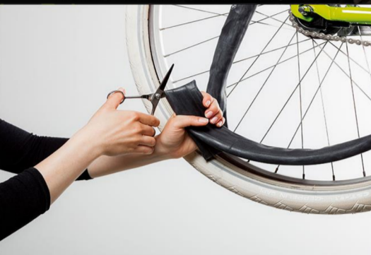
Schritt 3 von 14: Alten Schlauch zerschneiden. Dieser sollte mit einer kleinen Schere zerschnitten werden. So ist es am sichersten.
