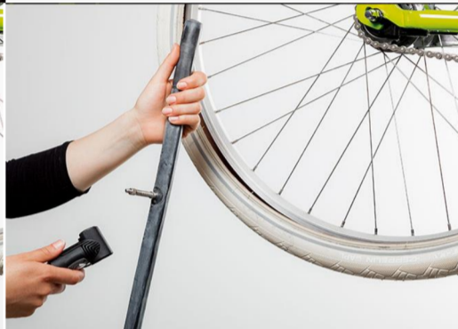
Schritt 6 von 14: Den GAADI-Fahrradschlauch vor dem Einlegen leicht aufpumpen. Das erleichtert das Montieren und verhindert ein Verdrehen des Schlauchs.
