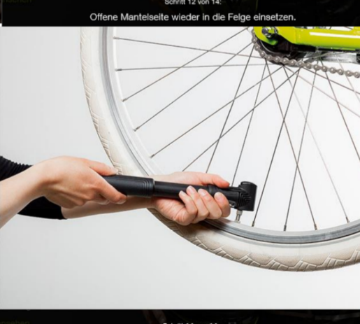
Schritt 14 von 14: Den Reifen aufpumpen und abschließend überprüfen, ob der Mantel sauber auf der Felge sitzt.
