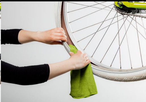
Schritt 4 von 14: Mantelinnenseite sorgfältig nach Scherben, etc. untersuchen.
