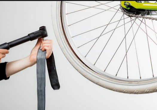
Schritt 5 von 14: Den GAADI-Fahrradschlauch vor dem Einlegen leicht aufpumpen. Das erleichtert das Montieren und verhindert ein Verdrehen des Schlauchs.
