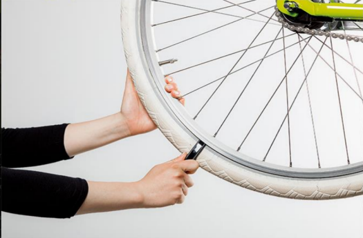
Schritt 1 von 14: Eine Seite des Mantels mittels Reifenheber von der Felge lösen.
