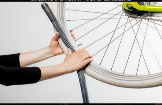
Schritt 7 von 14: Das Ventil zuerst in das Ventilloch der Felge stecken.
